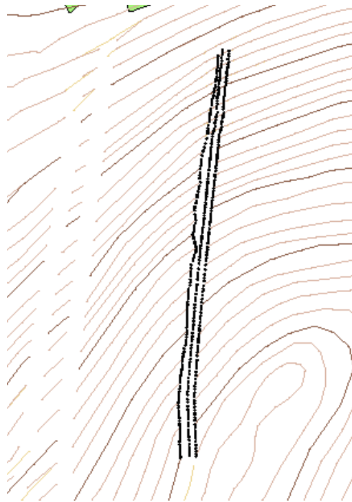
Obr.9 Vynechané vrstevnice vlevo a linie převedené na body s doplněnou výškou vpravo.
