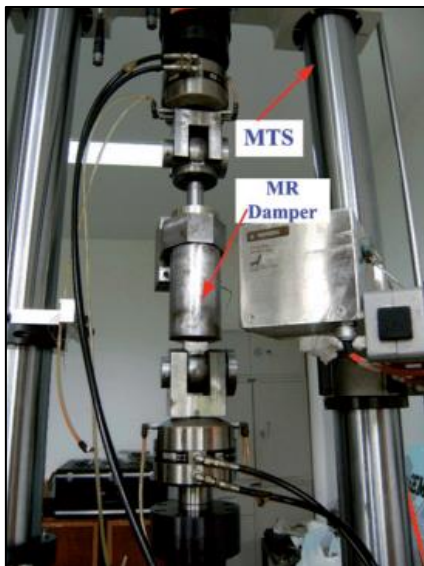
Obrázek 4.8 Testovací sestava tlumiče (Guo) [35]
