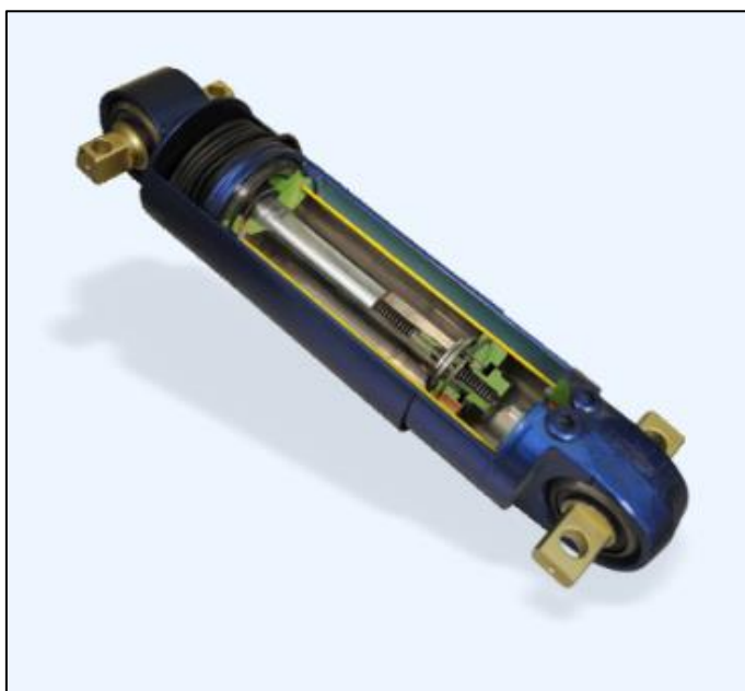
Obrázek 3.12 Řez tlumičem řady P8 (Strojírna Oslavany) [31]
