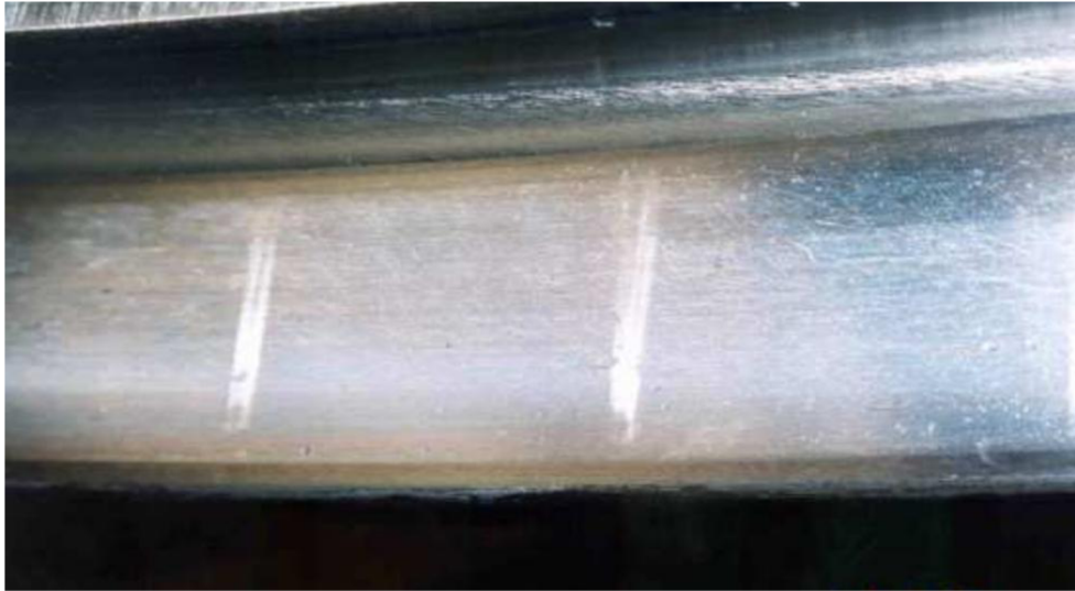
Obr. 4 Falešný brinelling na kontaktní ploše valivého ložiska [10]
