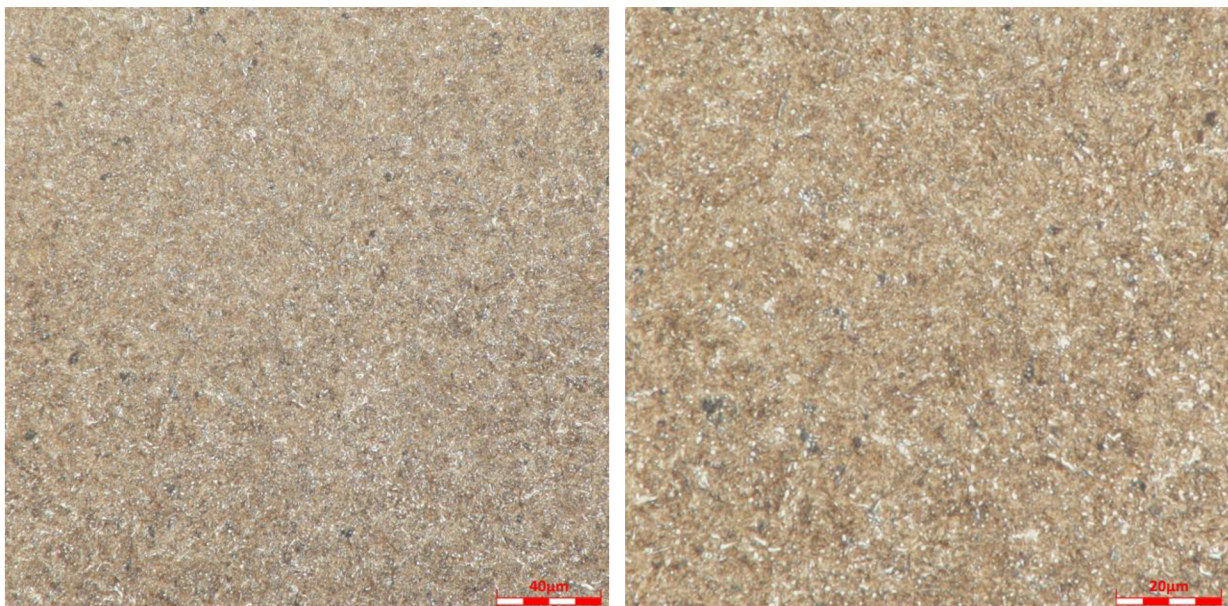
Obr. 7 Struktura oceli 100Cr6 po martenzitickém kalení, (LM, zv. 1200x (vlevo), 2400x (vpravo), Nital) [15]
