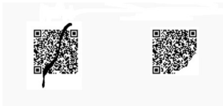
Obrázek č. 2: Příklady poškození QR kódu
