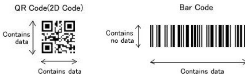
Obrázek č. 1: Rozdíl mezi QR kódem a čárovým kódem
