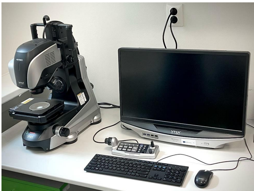
Obr. 8 Digitální mikroskop Keyence VHX-7000 (foto autorka)
