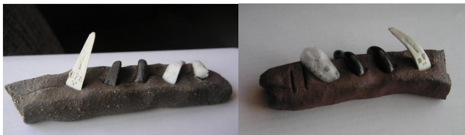
Obr. 13 Žároměrky před a po výpalu v peci
