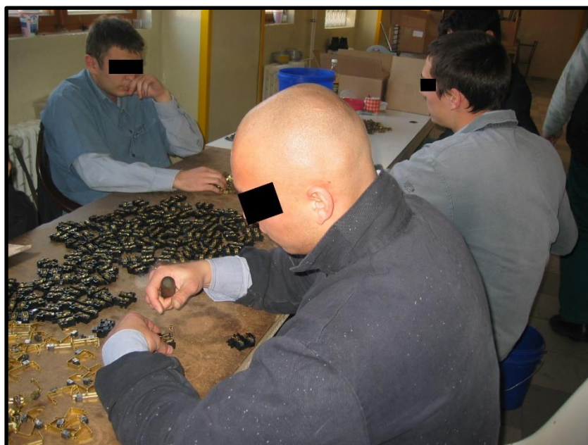
kompletace elektro zásuvek a vypínačů
