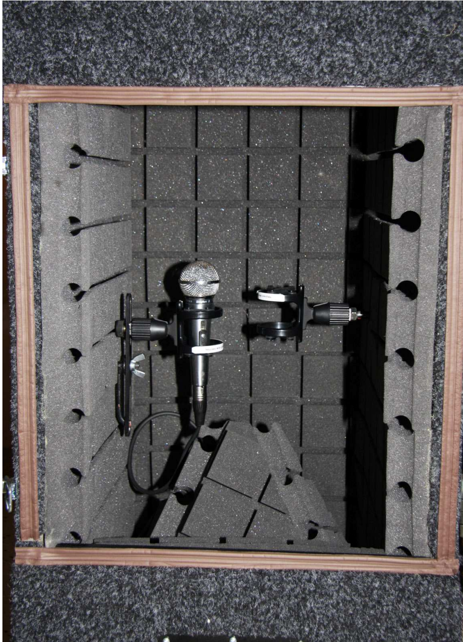
Obr. 4.6 Detail uchycení objímek mikrofonů pro kompenzační metodu měření
