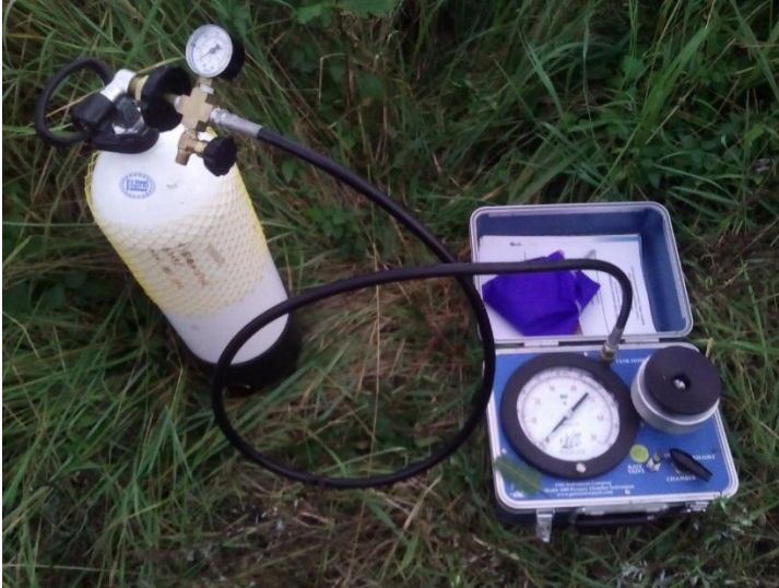
Obr. 10: Příklad Pressure Chamber Instrument s tlakovou lahví
