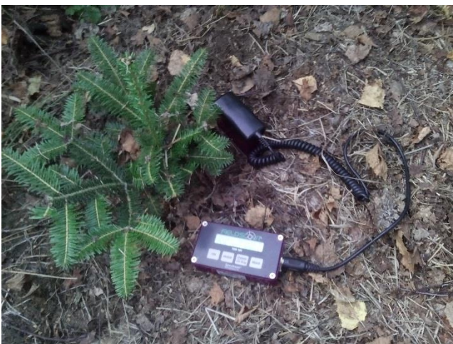
Obr. 11: Příklad FieldScout; měření půdní vlhkosti
