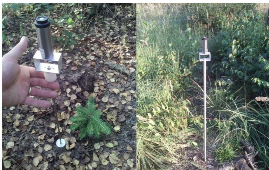
Obr. 9: Čidla pro měření FAR
