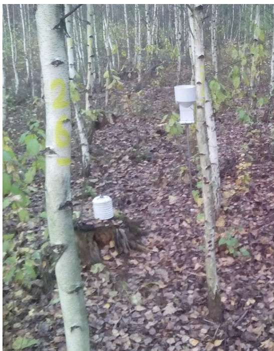
Obr. 7: Meteostanice umístěná v porostu
