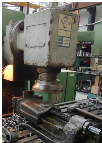
Obr. 4.1 Frézování zkoušeného obrobku.
