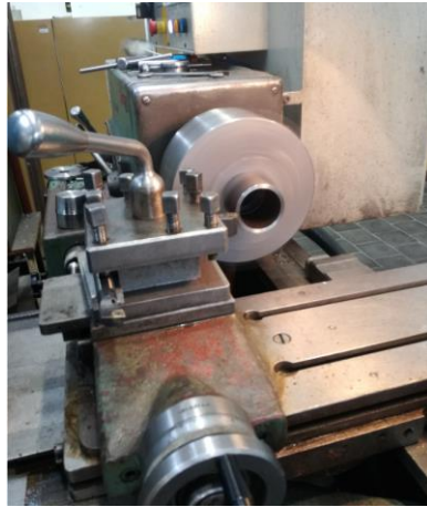
Obr. 4.5 Soustružení čelní plochy obrobku.
