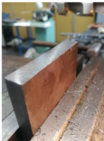
Obr. 4.2 Otřep po frézování.
