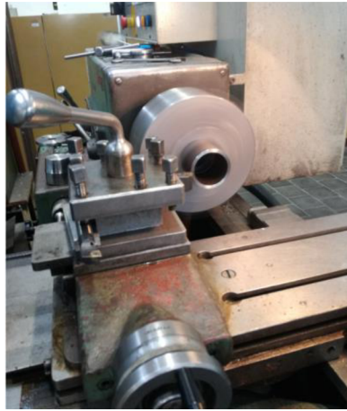
Obr. 4.5 Soustružení čelní plochy obrobku.
