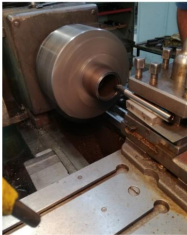
Obr. 4.6 Soustružení vnitřní plochy obrobku.
