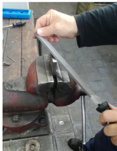
Obr. 4.4 Odstranění otřepu pilníkem.
