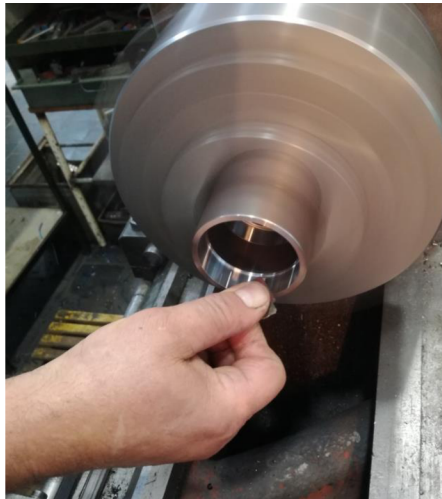
Obr. 4.8 Odstranění otřepu smirkovým papírem.
