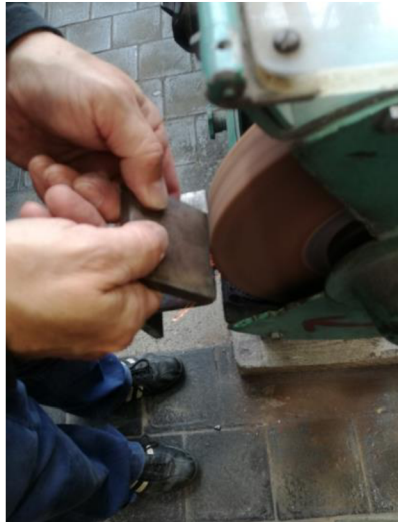
Obr. 4.3 Odstranění otřepu bruskou.
