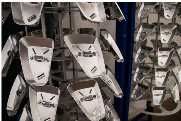
Obr. 14 Dílce pokovené vakuovou metodou [25]
