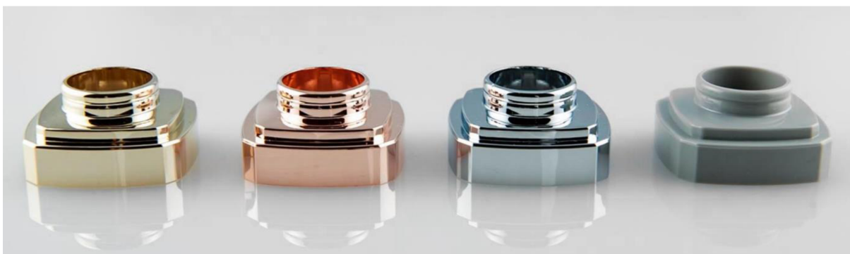
Obr. 3 Porovnání vzhledu pokoveného a nepokoveného plastu [23]
