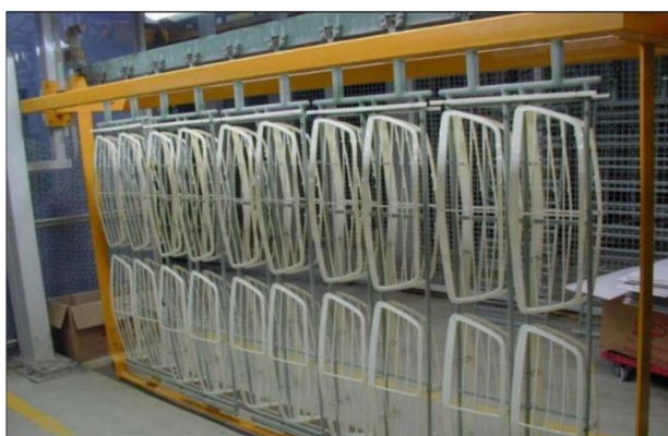
Obr. 5 Zavěšené dílce pro pokovování [23]
