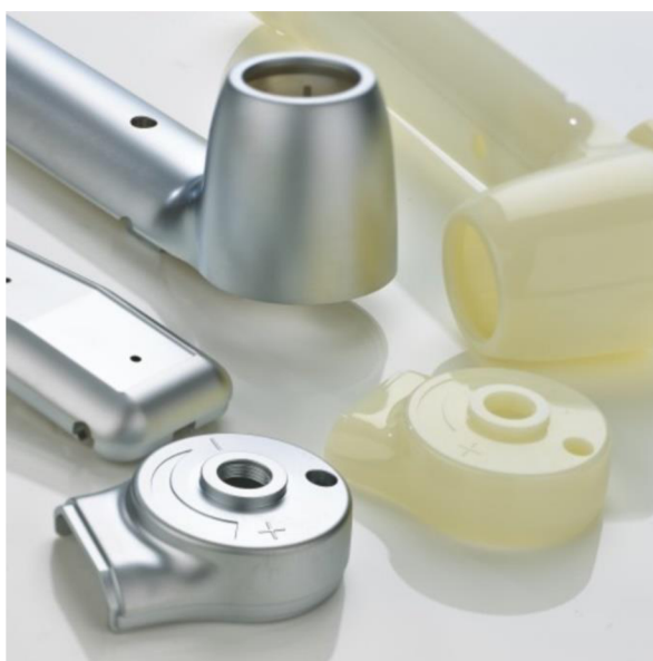
Obr. 4 Povrch nepokoveného a pokoveného ABS [27]
