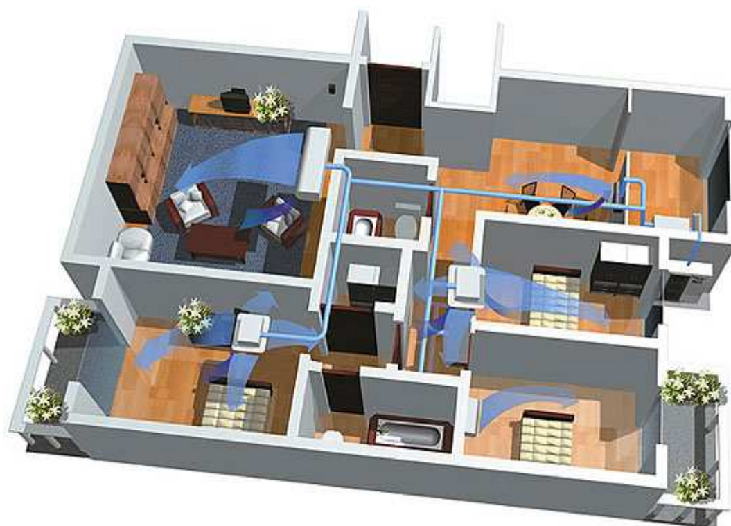
Obr. 10 Rozvod vzduchu ventilačním potrubím [11].
