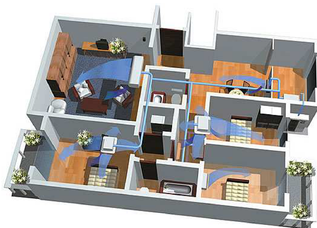
Obr. 10 Rozvod vzduchu ventilačním potrubím [11].
