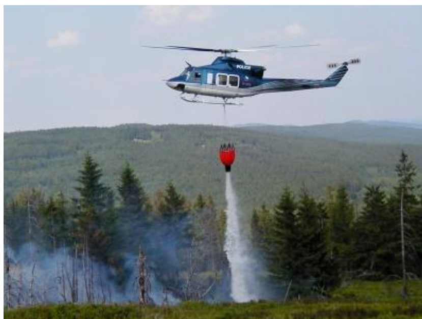
Obrázek 1 - Hašení požáru lesa pomocí hasícího vaku (HZS ČR 2017)
