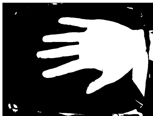
(d) Maska ruky vlnovej dĺžky 460 nm. získaná znížením hraničnej hodnoty OTSU prahovania.
