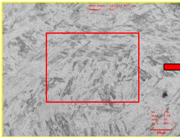
Obr. 60 Mikroskopická struktura svarového kovu vzorku č. 1, objektiv 50x.
