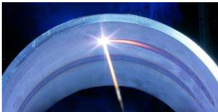
Obr. 8 Provaření materiálu laserovým paprskem režimem keyhole [36].
