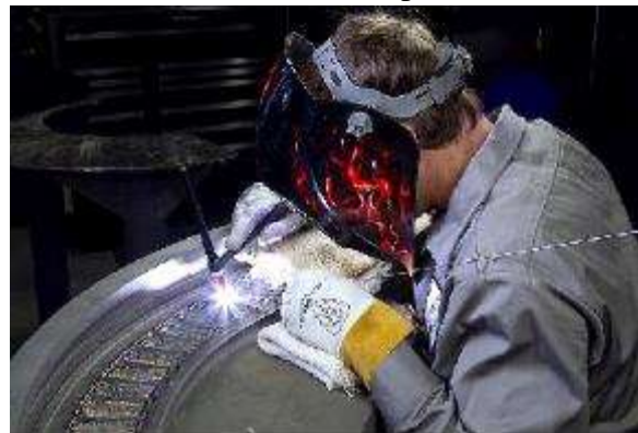
Obr. 3 Svařování rozváděcího kola pomocí technologie TIG [15].
