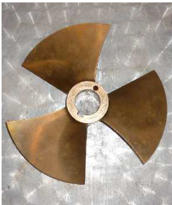
Obr. 1 Tří lopatové provedení vírové turbíny s 25 % nábojem 3 – VT – 200
