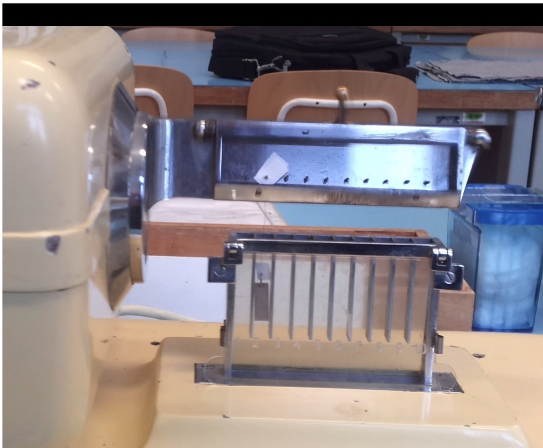
Obrázek č. 13 zařízení na dvoj ohyb
