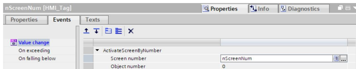
Obr. 35) Vlastnosti HMI tagu nScreenNum – Events
