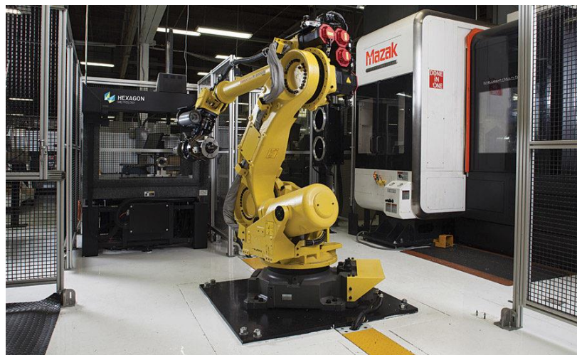
Obr. 3) CMM Hexagon v kooperaci s obráběcím centrem Mazak a robotem Fanuc [11]
