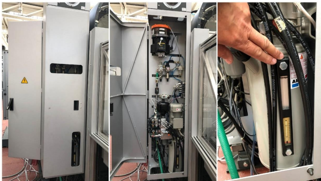
Obr. 21: Znárodnění činnosti kontrola výšky hladiny v nádrži hydraulického agregátu pomocí obrázků
