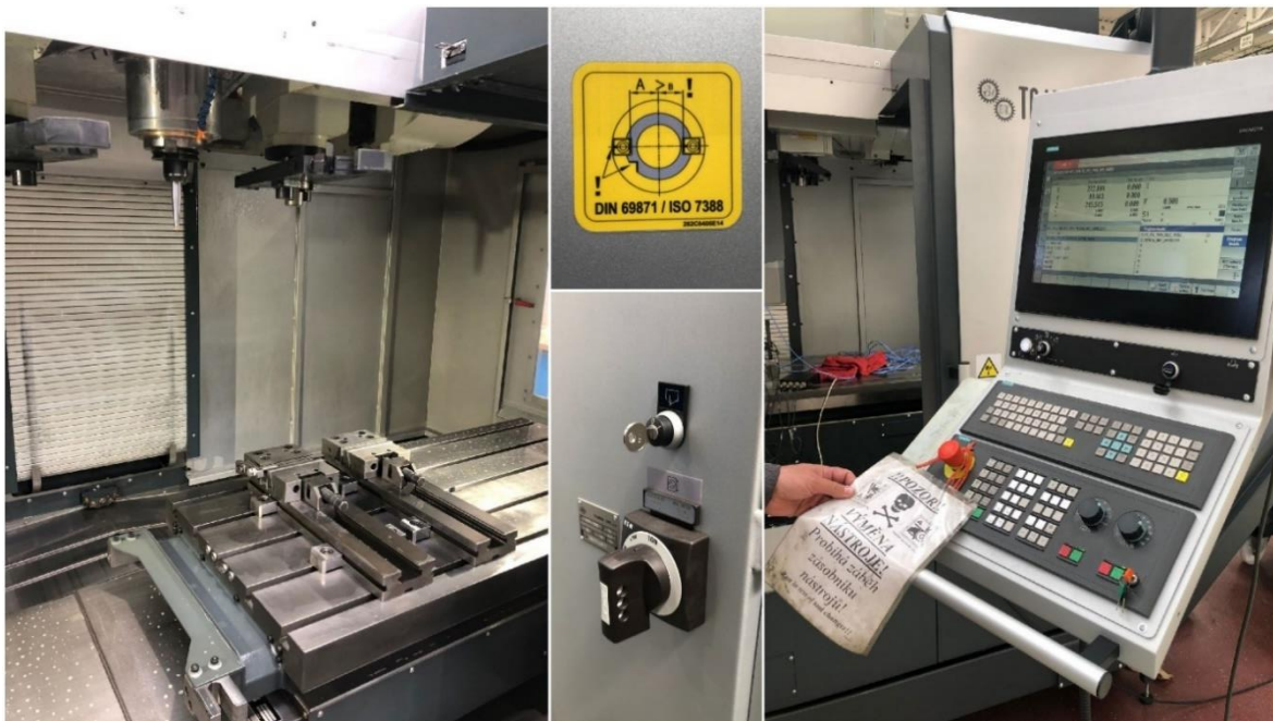
Obr. 11: Znárodnění činnosti vkládání nástroje do zásobníku nástrojů přes vřeteno pomocí obrázku
