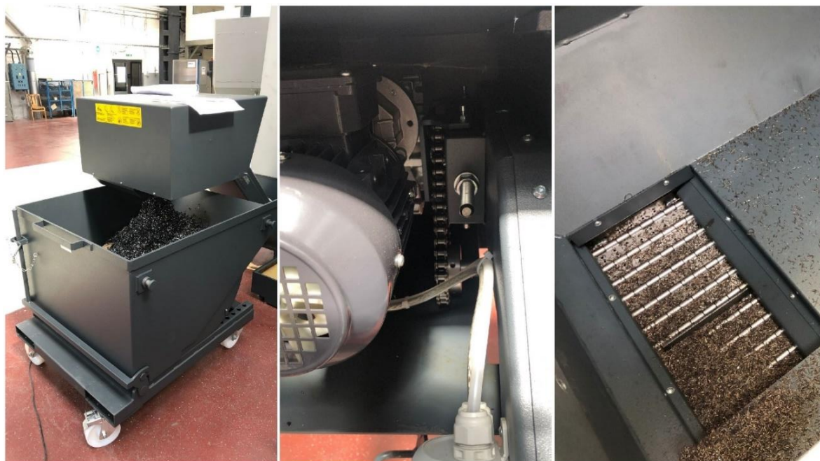
Obr. 25: Znárodnění činnosti napínání pásu článkového dopravníku třísek pomocí obrázků
