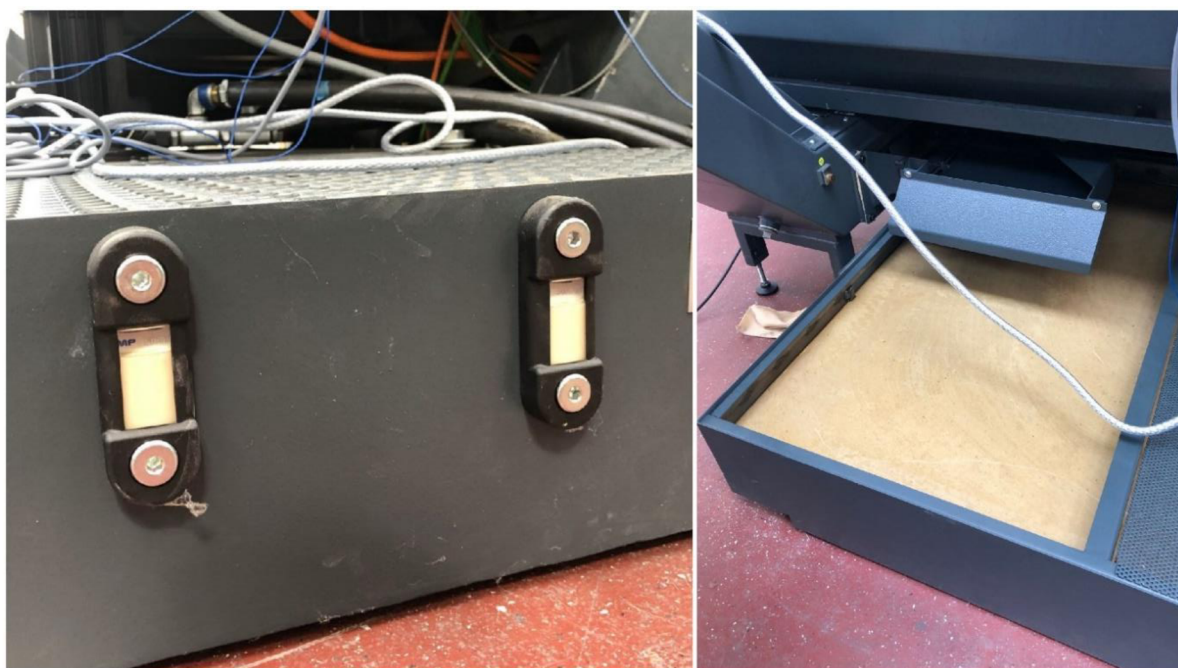
Obr. 19: Znárodnění činnosti kontrola výšky hladiny chladicí kapaliny pomocí obrázků
