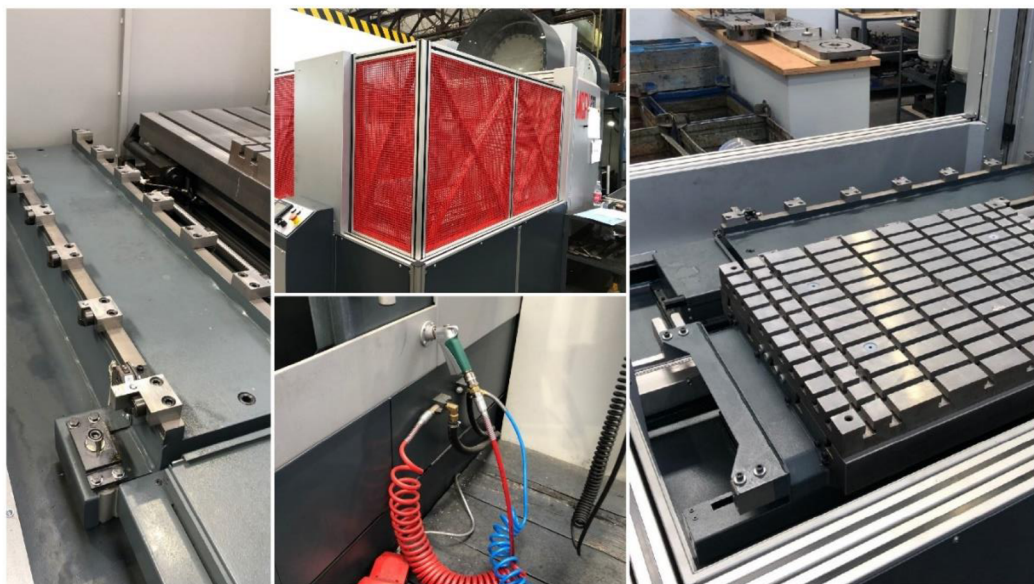
Obr. 17: Znárodnění činnosti čištění prostoru automatického výměníku palet pomocí obrázků
