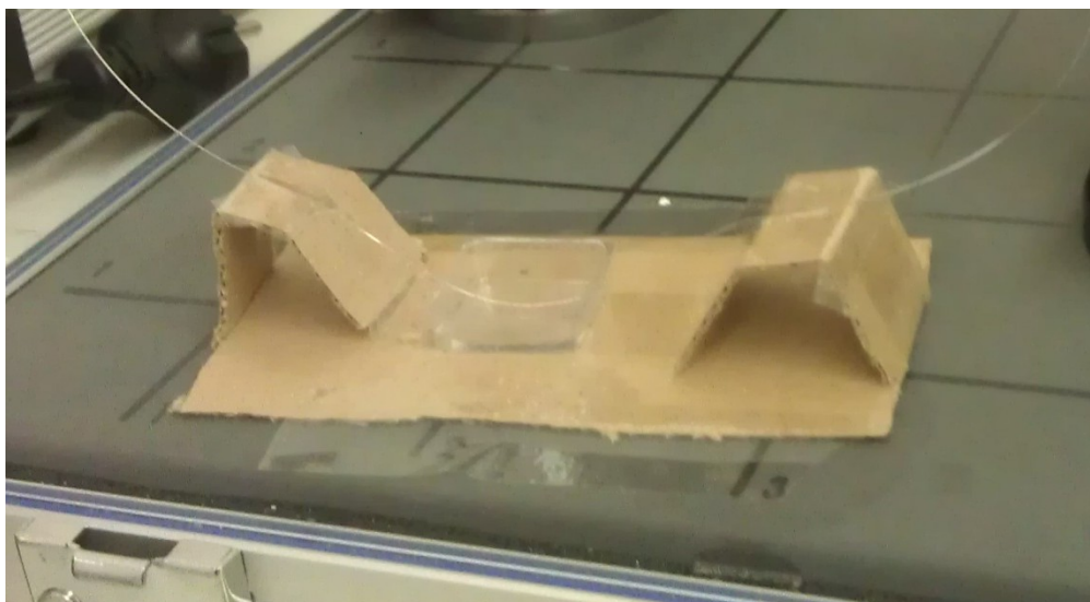
Obrázek 22: Snímací část senzoru s vláknem FM-340
