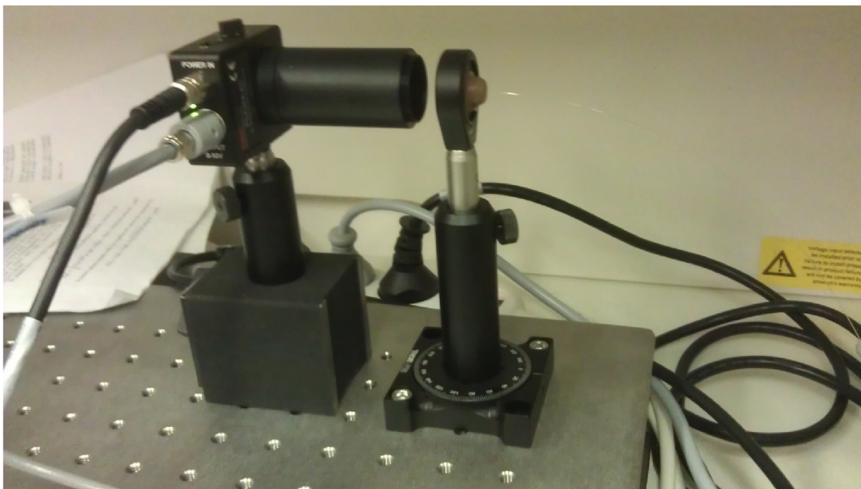
Obrázek 15: Detail vlastního měření NA (detektor vlevo, držák vpravo)
