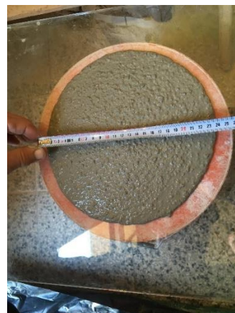
Obr. 6 Měření velikosti rozlivného „koláče“ – foto autor
