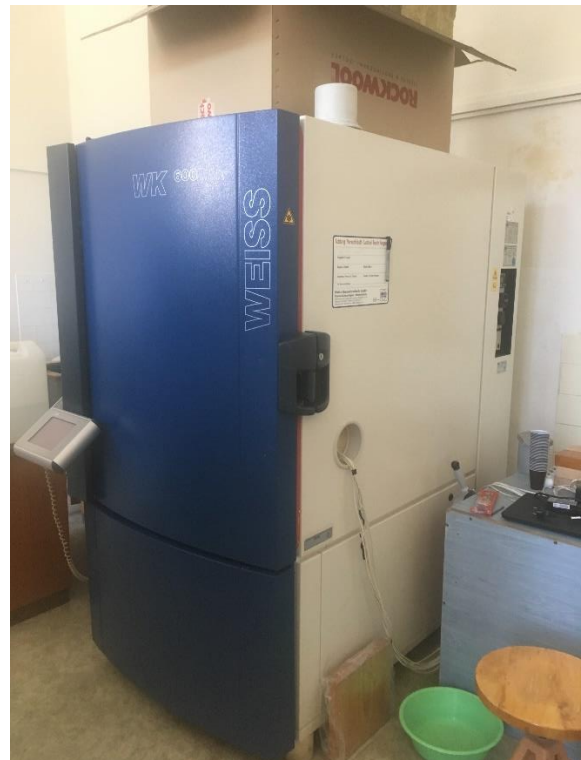
Obr. 18: Vzhled klimatické komory WEISS
