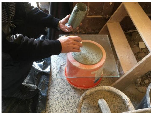
Obr. 5: Zvednutí rozlivného kužele – foto autor
