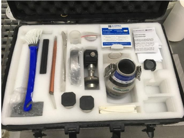
Obr. 19: Fotografie součástí CM přístroje – foto autor
