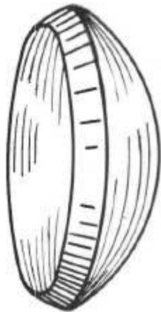
Obrázek 5: Výbrus pro ultrazvukové měniče (1, str. 48)
