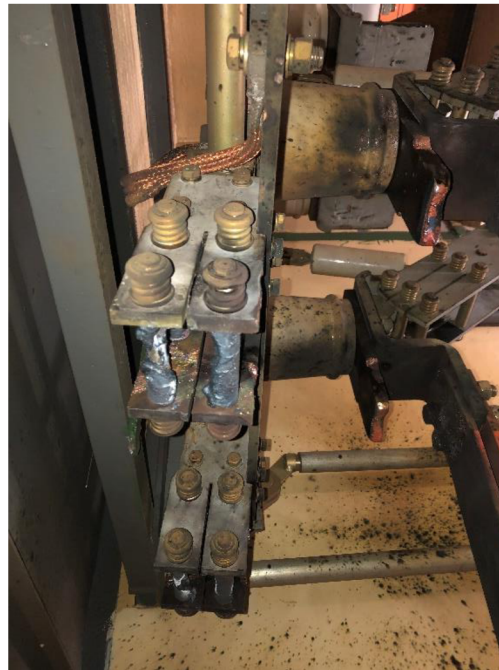
Obr. 1.2 Nože uzemňovača po skrate
