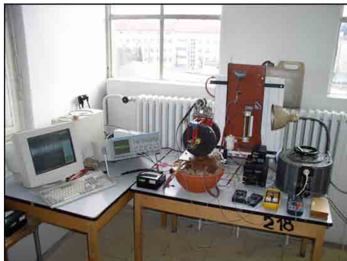
Obr. 4.3: Fotografie Stirlingova motoru při měření zatěžovacích charakteristik.
