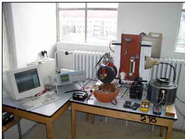
Obr. 4.3: Fotografie Stirlingova motoru při měření zatěžovacích charakteristik.
