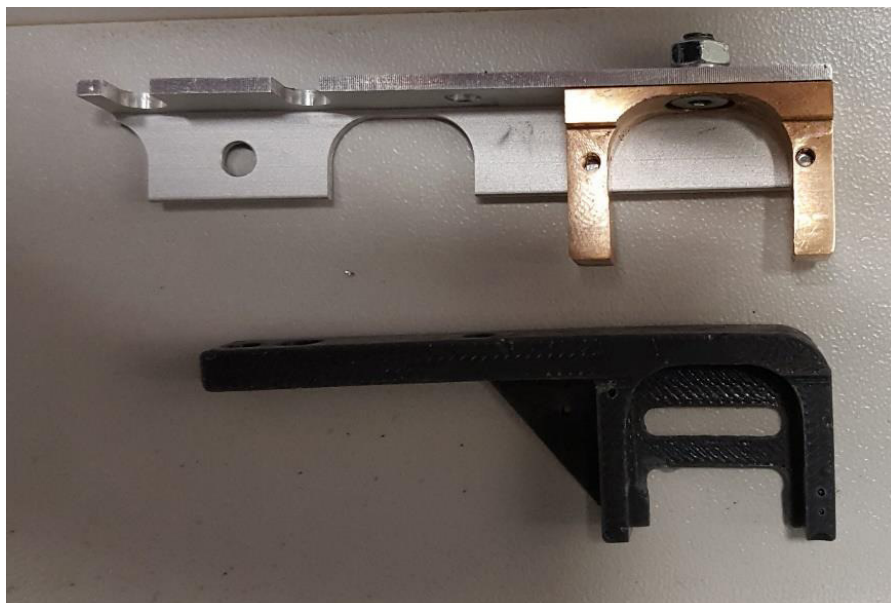
Obrázek 24 Výměna plastové části mechanismu za kovovou
