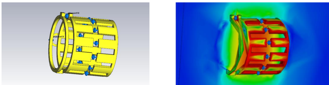
Obr. 11 a: Pohled na obvyklý způsob konstrukce ladění birdcage cívky a simulaci pole promítnutou na řezu
