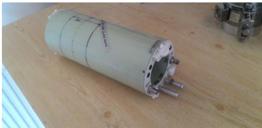
Obr. 23: Komerční lineárně polarizovaná birdcage cívka Bruker BIO-PRK Res. 200EPI 112/072.
