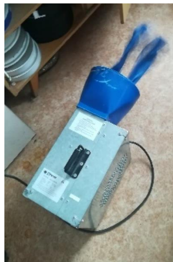
Obrázok 51 Trepací prístroj STFans s nainštalovanými vzorkami počas testu
