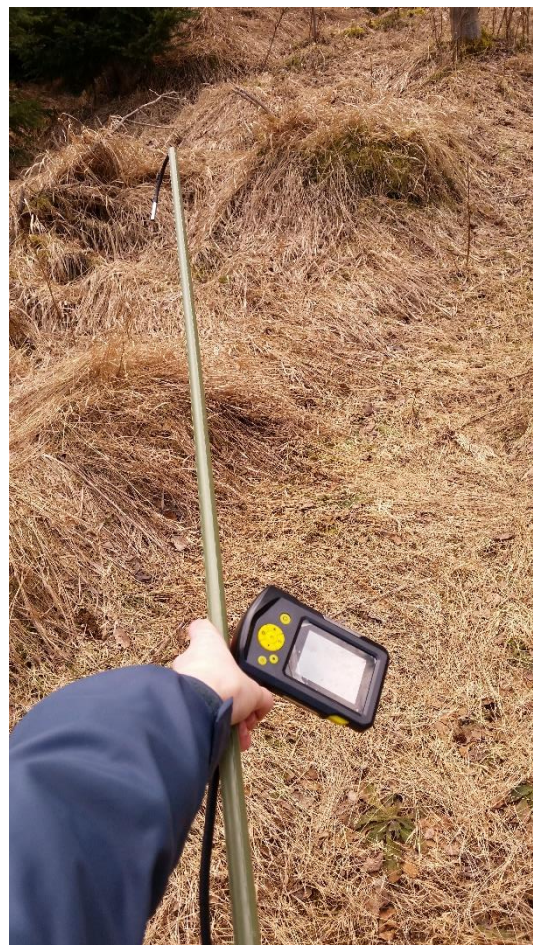
Příloha 4: Kontroly budek za pomoci revizní kamery s LCD displejem a světlem.
