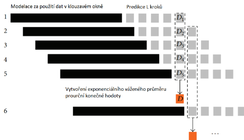
Obr. 3.10: Metoda exponenciálně váženého klouzavého průměru. Převzato z [42].
