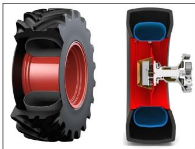
Obr. 23 Detail akumulčního zásobníku AirCell v pneumatice Mitas ( agricolturanews.it , 2016)
