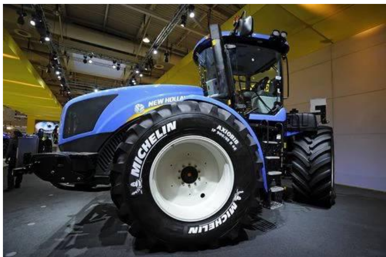
Obr. 18 Nízkotlaká radiální pneumatika konstrukce IF o šířce 900 mm a průměru ráfku 46'' (obrazky, 2017)
