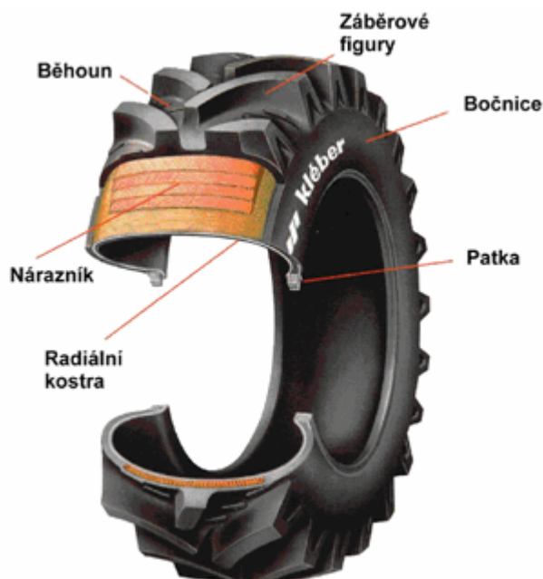
Obr. 16 Řez pláštěm radiální traktorové pneumatiky (Google, 2017)
