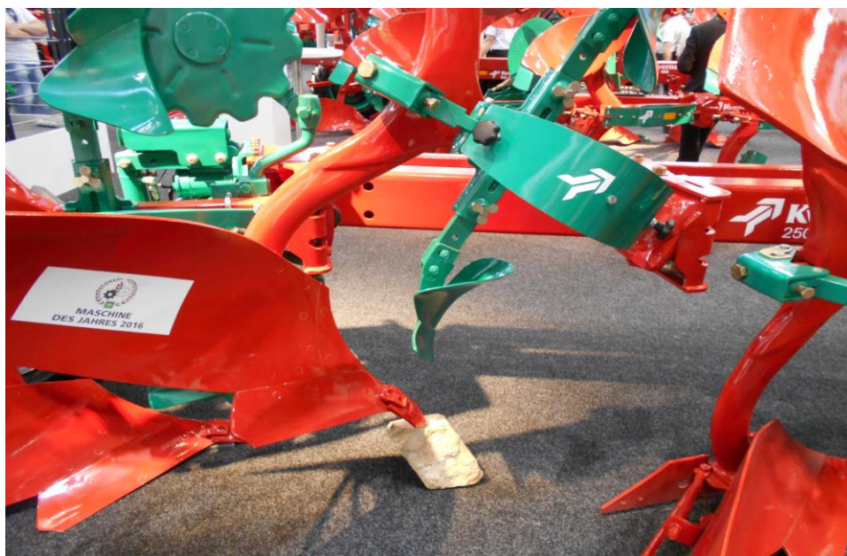
Obr. 9 Jištění pluhu Kverneland za pomoci listové pružiny (foto autor)
