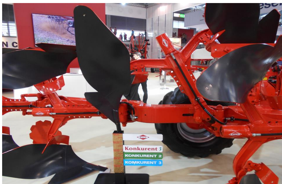
Obr. 10 Hydraulické jištění orebních těles od společnosti Kuhn (foto autor)
