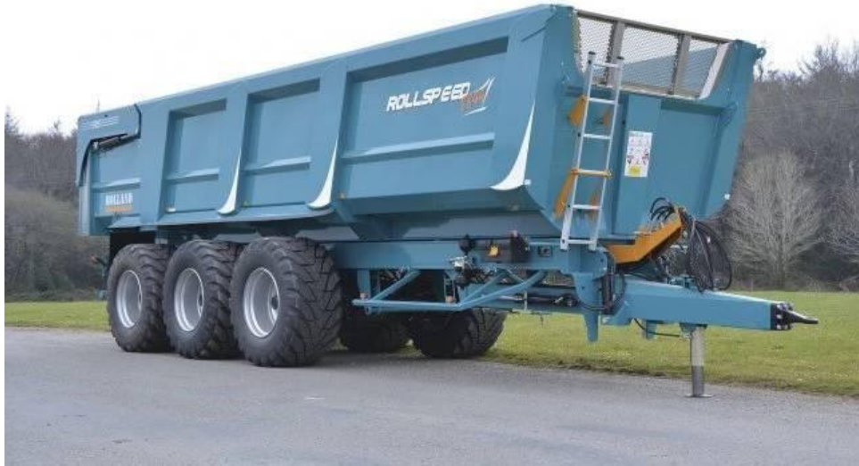
Obr. 19 Využití flotačních pneumatik pro velkoobjemové vozy. (obrazky, 2017)
