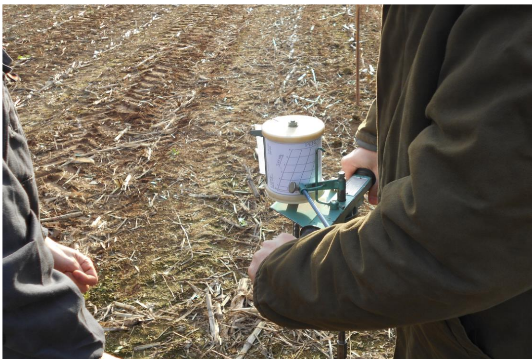
Obr. 25 Praktická ukázka měření odporu půdy za pomoci penetrometru (foto autor)
