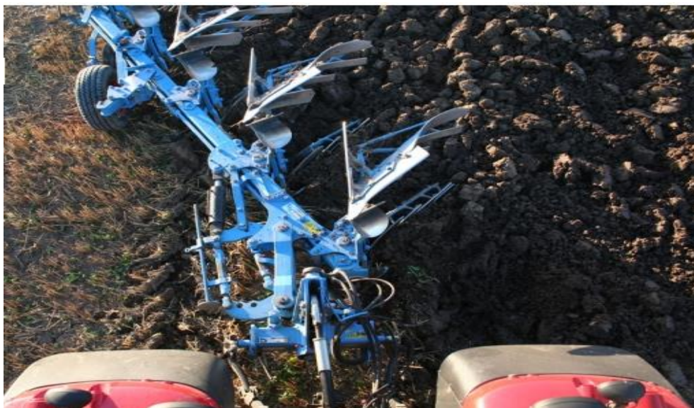
Obr. 4 Nesený otočný pluh s plynulou změnou záběru Lemken VariOpal (Lemken, 2016)
