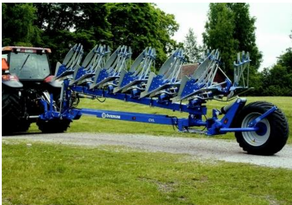
Obr. 2 Oboustranný návěsný 6 radličný pluh Overum CLV (Pekass, 2016)
