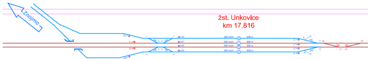
Obrázek 20: Schéma napojení VRT na terminál Unkovice (modrá – VRT Brno – Znojmo, hnědá – VRT Brno – Vranovice, fialová – silnice R52)
