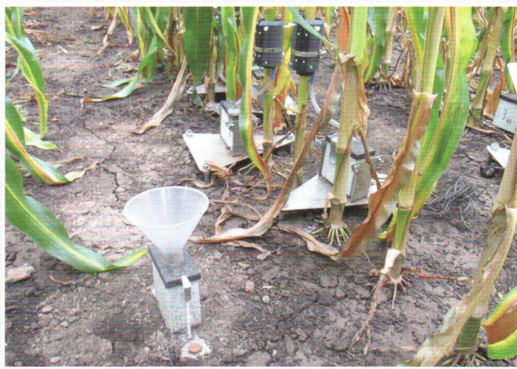
Měřicí systémy pro měření porostní srážky a stoku po rostlině v porostu kukuřice
