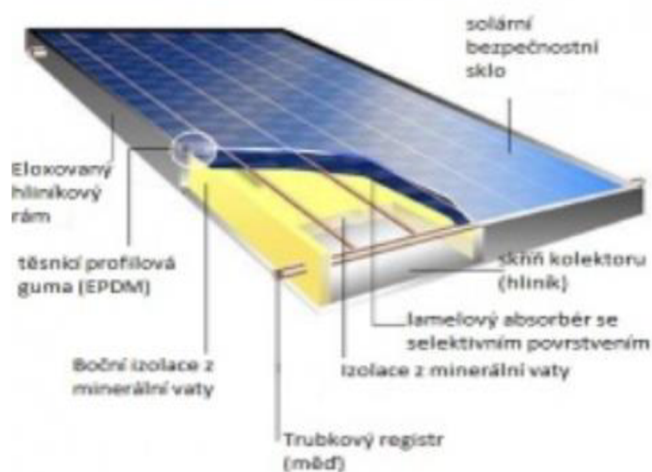
Obrázek 6 Konstrukce solárního kolektoru
