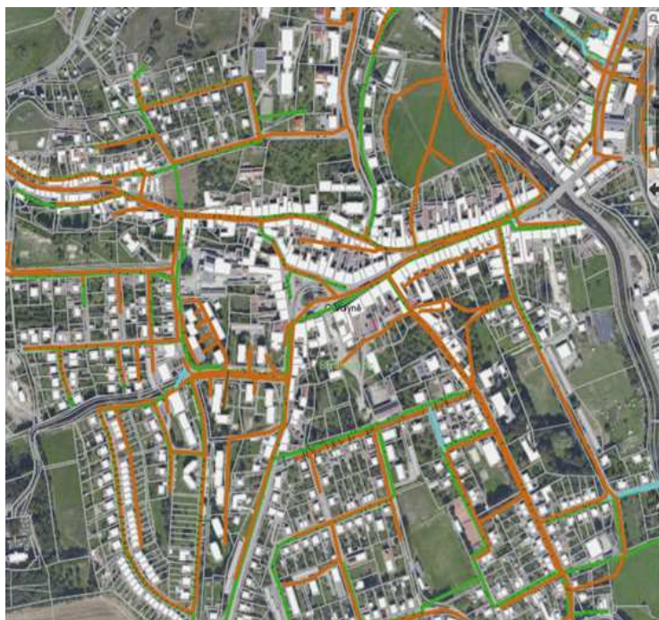
Obrázek 3 - Vodovodní a kanalizační síť ve Volyni v AutoCAD Map 3D – současné zobrazení ortofota a digitálního katastru[3]
