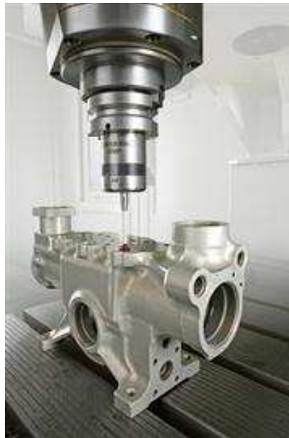
Obr. 4.9 Měření obrobku dotykovou sondou Renishaw. [38]
