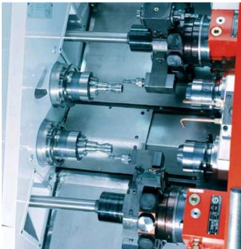
Obr. 4.1 Pracovní prostor soustružnického obráběcího centra Emcoturn 420. [33]
