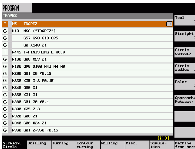
Obr. 4.2 Zapisování ISO kódu přímo v řídicím systému Sinumerik. [34]
