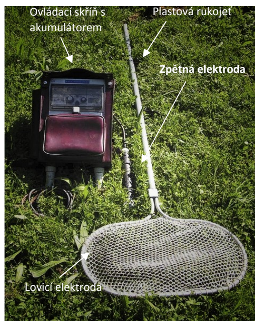
Obr. 22: Elektrický agregát – akumulátorový (Zdroj: https://www.ceskyrybar.cz/cz/rubriky/zajimavosti/lov-ryb-elekrinou-ii-elektricky-agregat-jeho-hlavni-casti-a-jejich-konstrukce )
