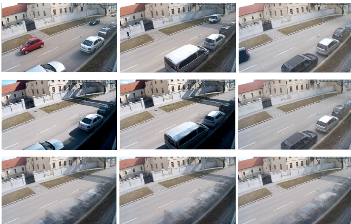
Obrázek 7.3: Dlouhodobý časový snímek z kamery na VUT FIT. Snímky jsou pořízeny tři následující dny po sobě. Shora dolů: 1) naivní časový snímek, 2) medián z denních snímků, 3) medián s aplikací posuvného průměrovacího okna. (Video na přiloženém CD: video/results/longterm/Cam1day.avi )
