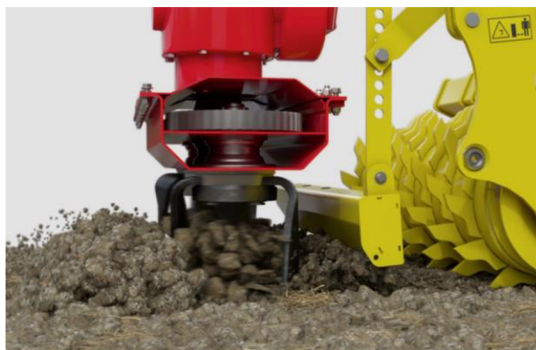
Obr. 29 Zadní smyková lišta – řešení výrobce Pöttinger [13]
