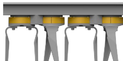
Obr. 26 Řešení ochrany výrobce Alpego HALF-ROCK GUARD [17]
