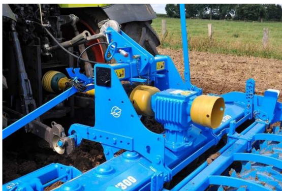
Obr. 28 Převodovka s dvěma vývodovými hřídeli [14]
