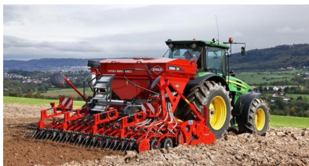
Obr.3 Kombinace rotační brány KUHN HR 4040 a pneumatického secího stroje VENTA NC 4000 [9]
