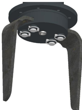
Obr. 47 Uchycení nožů rotační brány v unašech
