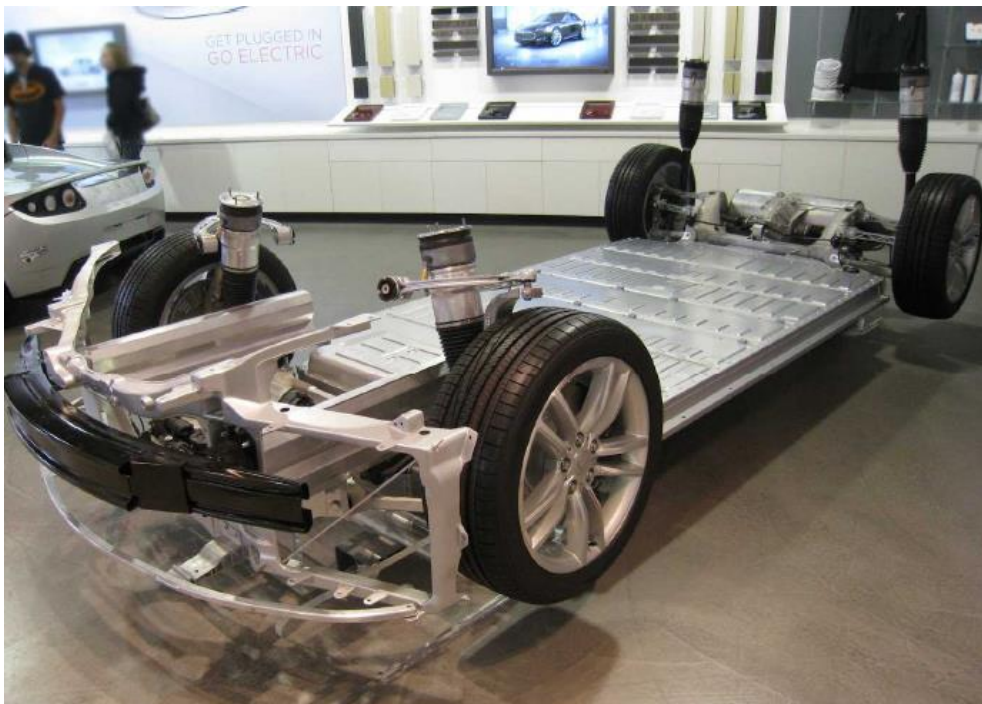
Obrázek 9: Tesla Model S – uložení baterie v karoserii automobilu
