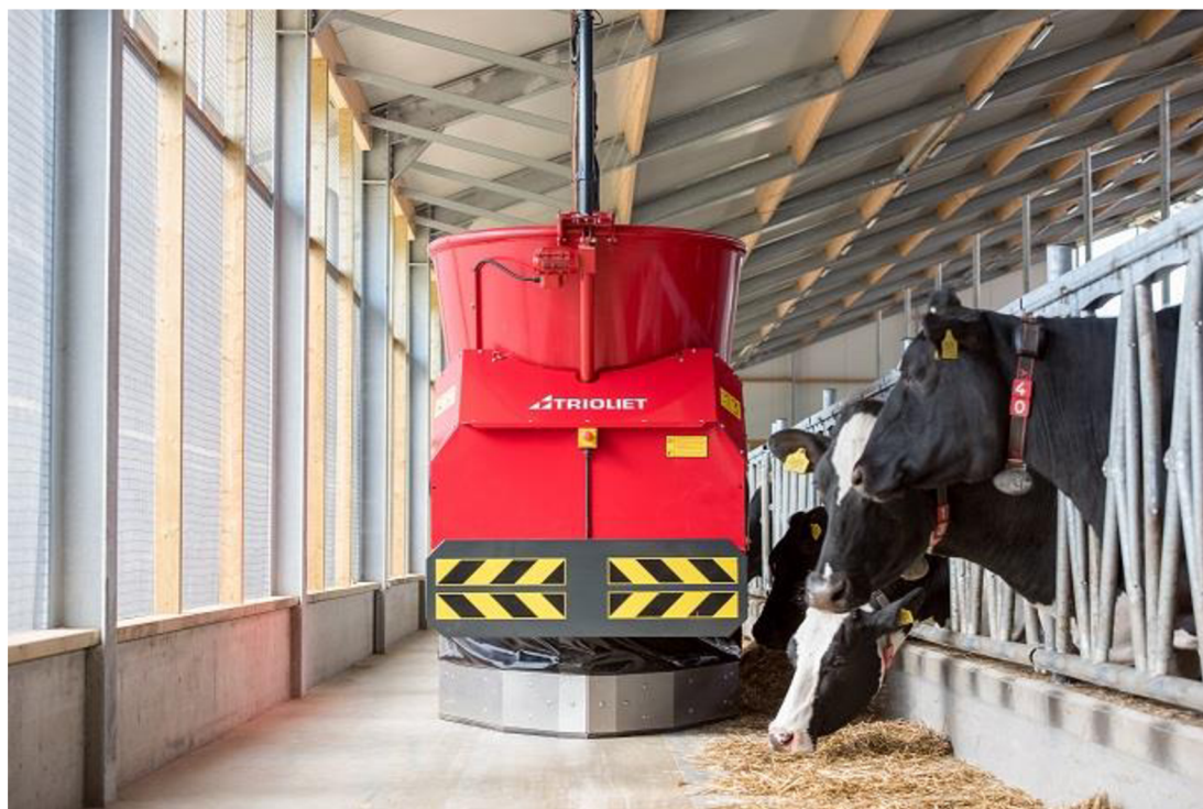
Obrázek 13 Inteligentní autonomní krmný vůz s vlastním pohonem a napájením přes vodící dráhu Triomatic WP 2 300 (Trioliet.cz, 2018)
