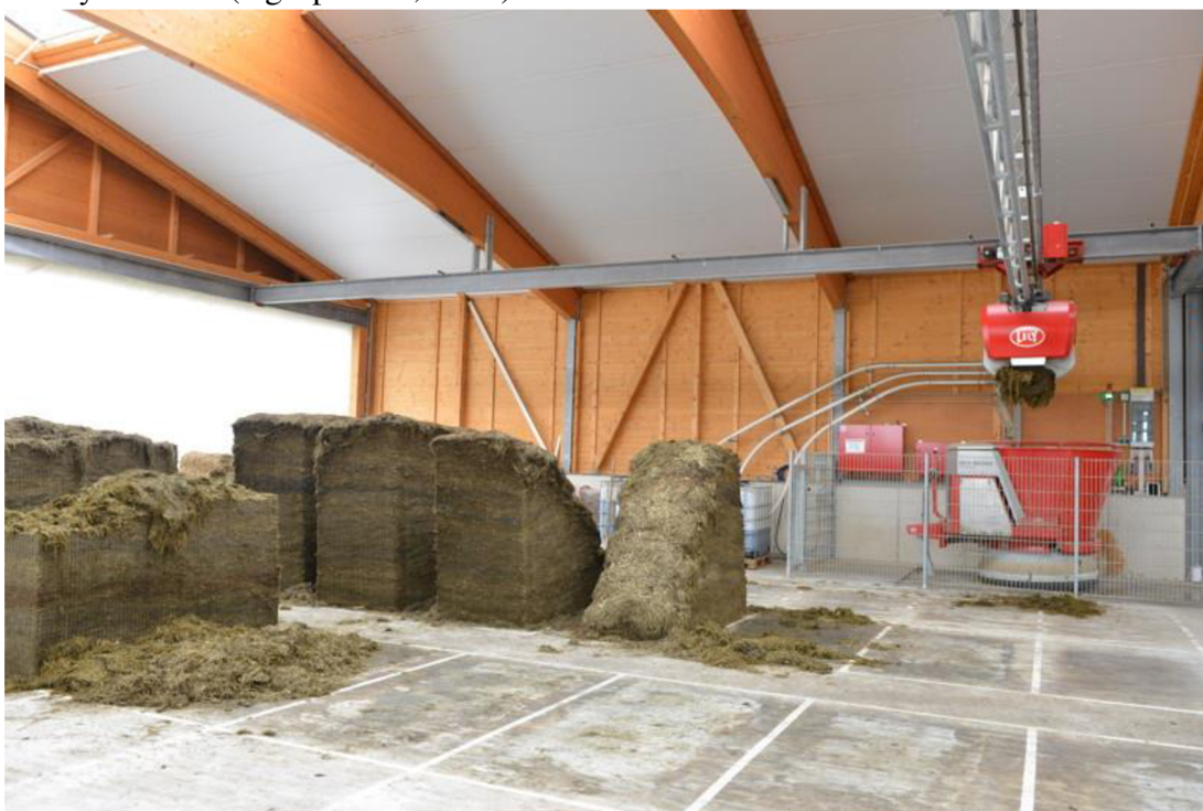
Obrázek 8 Pohled na krmnou kuchyni s portálovým jeřábem Lely Vector (Lely.com, 2014)
