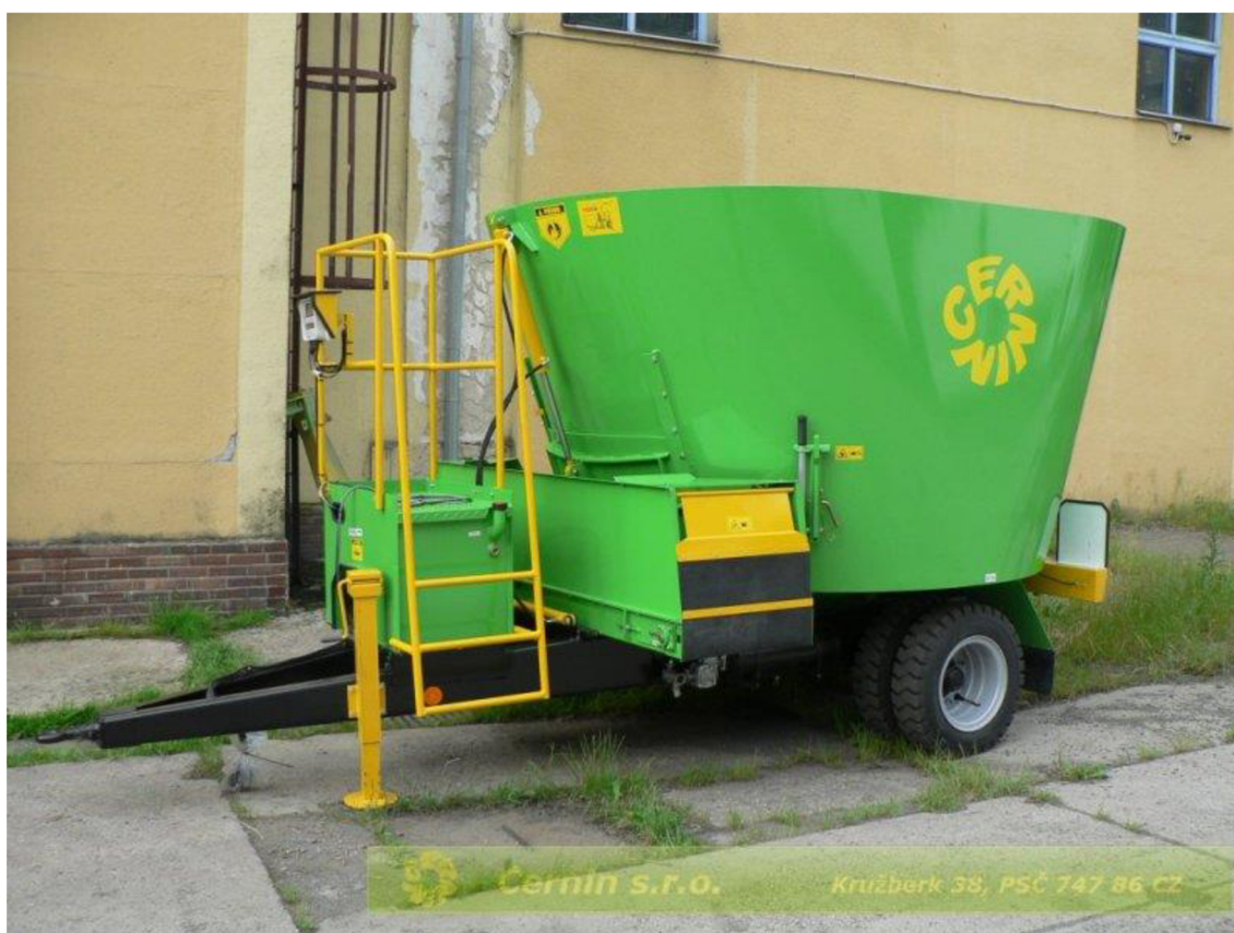
Obrázek 5 Míchací krmný vůz s vertikálním míchacím zařízením návěsné bez vlastního nakládání ČERNÍN (Černín.cz, 2014)
