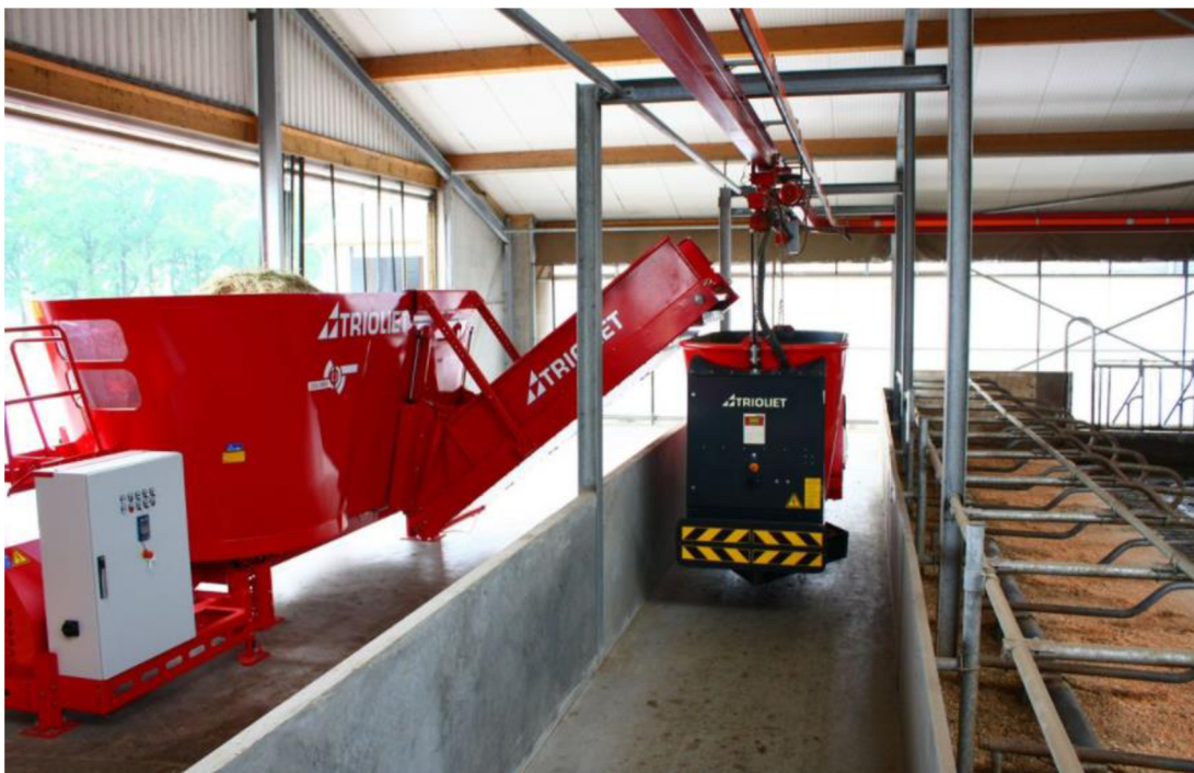
Obrázek 10 Pohled na krmnou kuchyni s se stacionárním míchacím a dávkovacím zařízením Trioliet T20 (Trioliet.cz)
