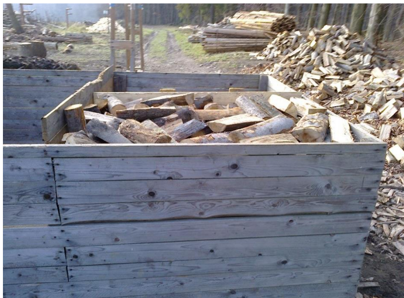
Obr. 6: Dřevěná odměrná nádoba zmenšená pro měření na 1,25 prm.
