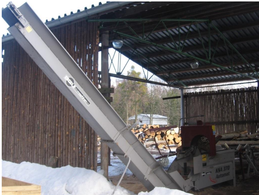
Obr. 4: Pásový dopravník pro transport poštípaného dříví do kontejneru
