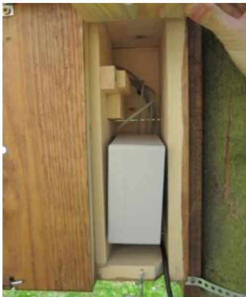
Obrázek 21. Způsob umístění řídicí jednotky (počítač) v prostoru zadní části budky (V. Kerdová, 2015)
