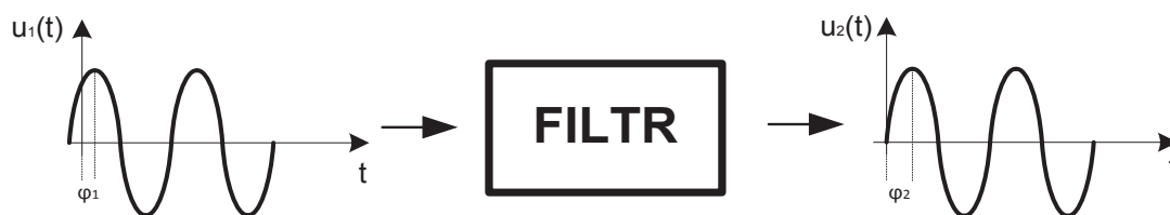
Obr. 1.2: Průchod harmonického signálu filtrem typu DP
