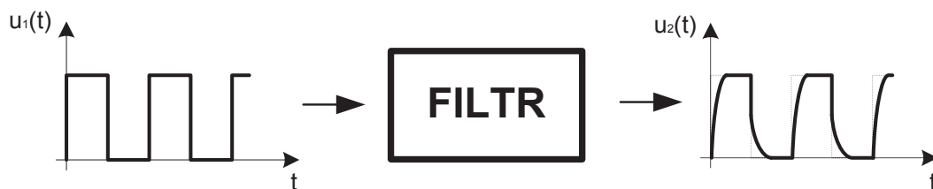
Obr. 1.3: Průchod obdélníkového signálu filtrem typu DP
