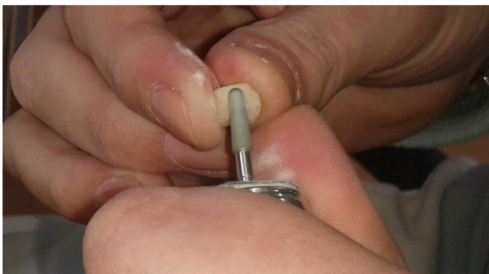
Obr. 4.3 Broušení povrchu vypálené dentální keramiky.
