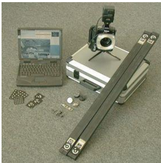
Obr. 2.7 Fotogrametrický systém Tritop [56].
