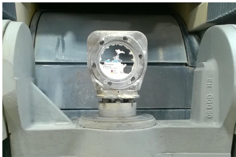
Obr. 3.5 Speciální držák materiálu s diskovým polotovarem z materiálu ZrO_2 TZP.
